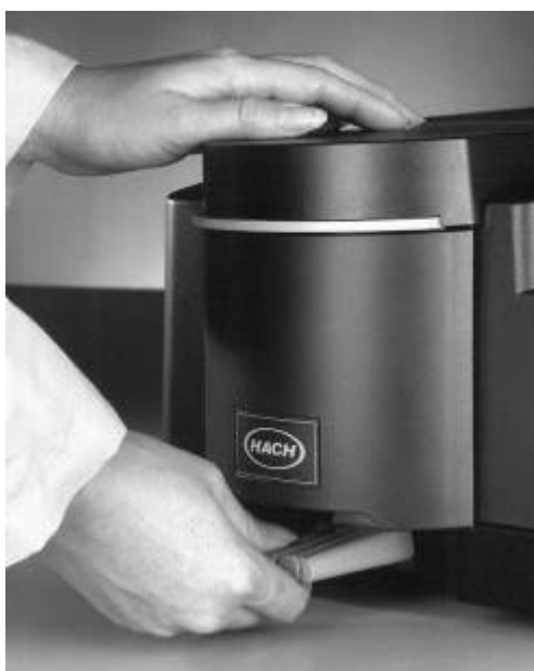
图 7 开启模块锁和取出模块
